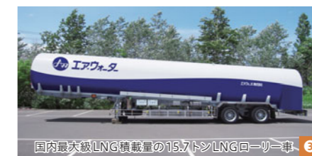
国内最大級LNG積載量の15.7トンのLNGローリー車 ③
