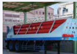
水素トレーラー
