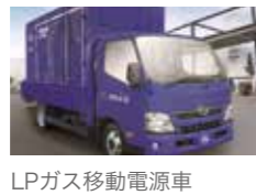
LPガス移動電源車
