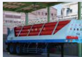
水素トレーラー
