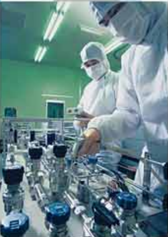
半導体製造用ガス供給装置の製作
