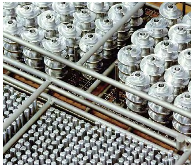
NV窒化による金属表面処理施工例
