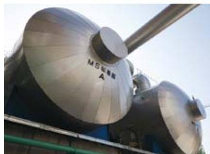
酸素圧縮機に高効率な新型ギアード式を採用。エネルギー効率を高める(左)、ガス供給配管。酸素・窒素・アルゴンをお客様のガス使用先まで直送する(中央)、前処理工程として、原料となる空気の不純物を除去する、高性能MS(分子吸着)吸着器(右)
