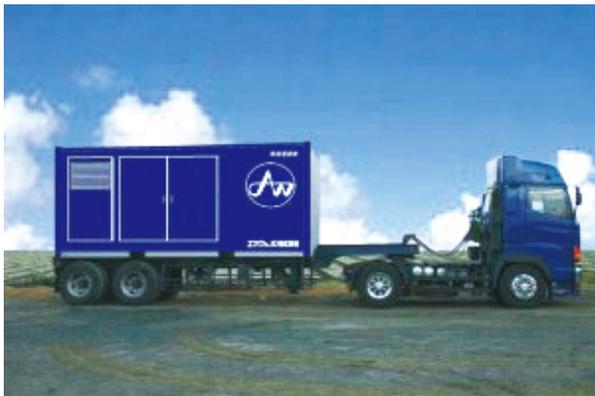
LPガス発電機を搭載した移動電源車
