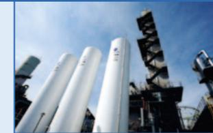
大型深冷空気分離装置
