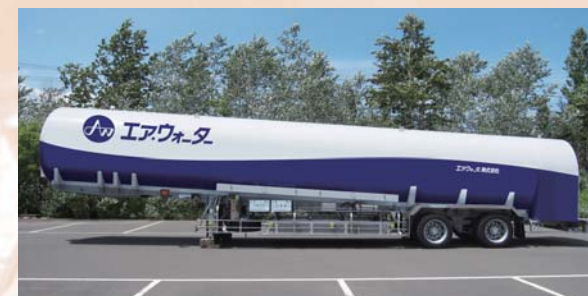
国内最大級LNG積載量の15.7トンLNGローリー車
