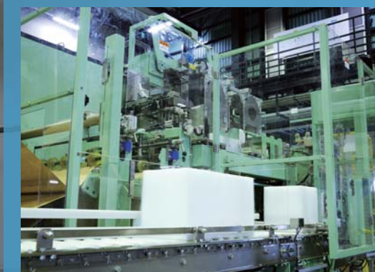
「ブロックドライアイス」製造ライン
