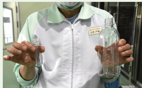
無菌充填では試験管サイズの樹脂素材から成型したペットボトルを用い、プラスチック使用量を半減
