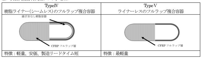
TypeIV・TypeVと呼ばれるCFRP(炭素繊維強化プラスチック)複合容器を指し、ロケット開発で最も重要となる「軽量化」の技術の一つです。金属容器または金属容器をライナーとして用いた従来品(Type I
