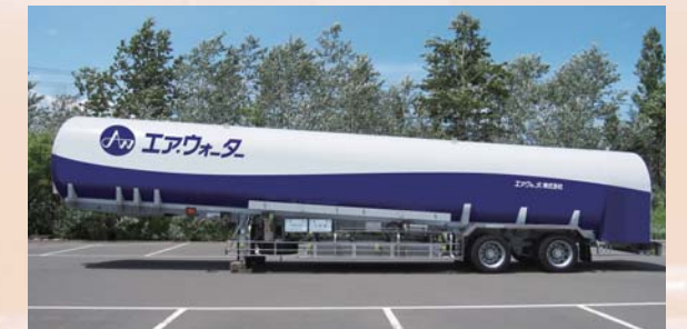
15.7-ton LNG tank truck with the largest LNG shipping capacity in Japan
