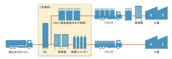
産業ガスの供給は、お客様のガス使用量や使用形態に応じて、シリンダー(ガスボンベ)、超低温液化ガス容器、ローリー供給、パイピングなど、様々な供給形態でガスを安定的にお届けしています。シリンダーや液化ガス容器による供給の中核拠点となるのは「充填所」と呼ばれる施設です。大型プラントやVSU(高効率小型液化酸素・窒素製造装置)などの製造工場で生産した液化ガスは、液化ガスローリーによって充填所まで輸送し、充填所に設置された CE タンク(液化ガスを貯蔵する大型タンク)に納入します。そして、これをシリンダーや液化ガス容器に1本ずつ小分けし、トラックに搭載してお客様にお届けします。
