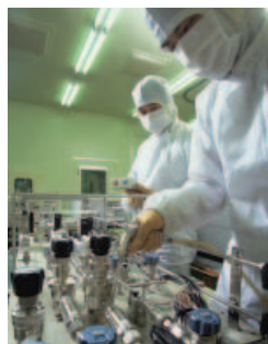
半導体製造用ガス供給装置の製作
